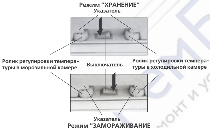
Рисунок 4 — Схема переключения режимов
